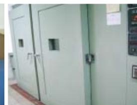
Câmara de teste de ciclos de temperatura
